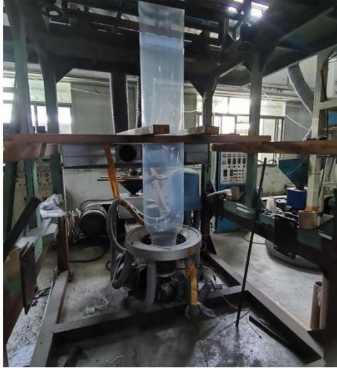
图 1 吹膜废气收集（整改前）
