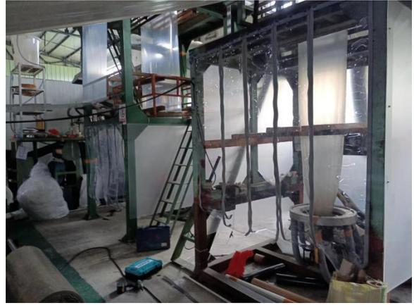
图 4 吹膜废气收集（四周胶帘围挡）
